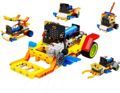
**SUPERBIT:** kit formado por piezas de lego technic que incluye una tarjeta de expansión donde se puede conectar y ampliar los sensores y actuadores de la tarjeta Microbit. Microbit es una tarjeta programable, que integra sensores y actuadores, y que está considerada como un miniordenador por las funciones que realiza y la facilidad de programar tanto en bloques como en código.
